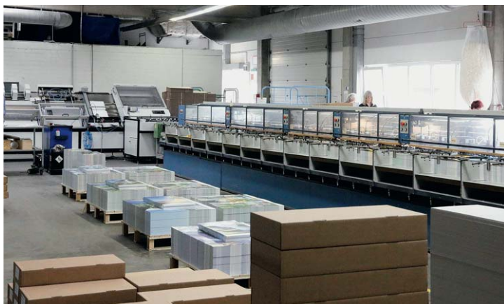
Jeweils eine Theisen & Bonitz-Zusammentragmaschine versorgt die beiden Inline-Anlagen von Renz automatisch mit Blatt-Formaten bis zu 50 x 70 cm.
